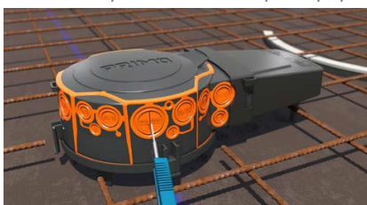
4. Отворете мембраната с нож за рязане. Поставете кабели и (твърди) тръби по желание без допълнителни инструменти. Благодарение на мембранната технология, системата остава абсолютно херметична към бетона.
